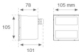
**Installation:** Encastré au mur**Mesures encastrement:** 107 x 112 x 135 mm**SPÉCIFICATIONS TECHNIQUES:**
