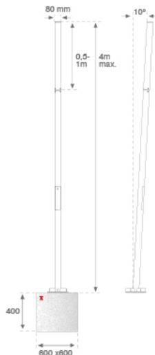
\* Dado autoportante de cimentación calculado para vientos iguales o inferiores a 29 m/s
