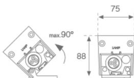
**CARACTERÍSTICAS TÉCNICAS:****Flujo de salida:** 1.484 lm**K:** RGBW**Plum:** 57W**Eficacia:** 26 lm/w**Alimentación:** 110-240V 50/60Hz**Fuente de Luz:** MID POWER AVAGO**Equipo:** Electrónico**Pled:** 51W
