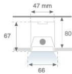
**Installation:** Encastré**Mesures encastrement:** 1,270 x 52 x 80 mm
