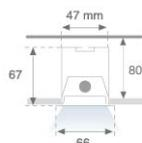
**Installation:** Encastré**Mesures encastrement:** 1,270 x 52 x 80 mm
