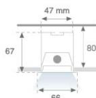
**Installation:** Encastré**Mesures encastrement:** 670 x 52 x 80 mm
