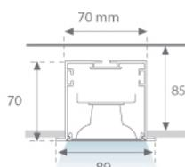
**Installation:** Encastré**Mesures encastrement:** 2,012 x 78 x 85 mm**SPÉCIFICATIONS TECHNIQUES:**
