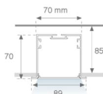
**CARACTERÍSTICAS TÉCNICAS:****Flujo de salida:** 3.215 lm**K:** 4000**Plum:** 26.8W**IRC:** 80**Eficacia:** 119,9 lm/w**MacAdam:** 3**Fuente de Luz:** MID POWER PHILIPS**Alimentación:** 220-240V 50/60Hz**Horas de vida led:** 50.000 L80 B10**Equipo:** Electrónico**Pled:** 25W**Tolerancia del flujo de salida +/- 10%**
