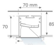
**Installation:** Encastré**Mesures encastrement:** 1,012 x 78 x 85 mm
