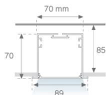
**SPÉCIFICATIONS TECHNIQUES:****Flux lumineux:** 3.328 lm**°K :** 3000**Plum:** 26,8W**IRC :** 80**Efficacité:** 124,2 lm/w**MacAdam:** 3**Type:** MID POWER PHILIPS**Alimentation:** 220-240V 50/60Hz**Durée de vie LED:** 50.000 L80 B10**Équipement:** Électronique**Puissance:** 25W**Tolérance de flux lumineux +/- 10%**
