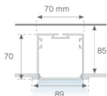
**SPÉCIFICATIONS TECHNIQUES:****Flux lumineux:** 3.450 lm**°K :** 4000**Plum:** 26,8W**IRC :** 80**Efficacité:** 128,7 lm/w**MacAdam:** 3**Type:** MID POWER PHILIPS**Alimentation:** 220-240V 50/60Hz**Durée de vie LED:** 50.000 L80 B10**Équipement:** Électronique**Puissance:** 25W**Tolérance de flux lumineux +/- 10%**
