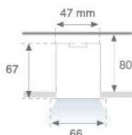
**Installation:** Encastré**Mesures encastrement:** 1,147 x 52 x 80 mm
