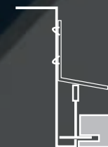
Perfilería "T" oculta, techo no desmontable
