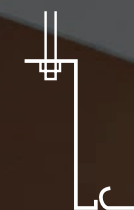
Montaje suspendido para techos de lamas o especiales *Solo en Air
