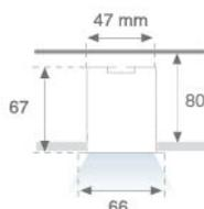
**Acabado:** Blanco mate RAL 9010**Dimensiones:** 1.700 x 66 x 67 mm**Peso:** 2.860 g**Instalación:** Empotrado**Medidas empotramiento:** 1.710 x 52 x 80 mm**CARACTERÍSTICAS TÉCNICAS:**
